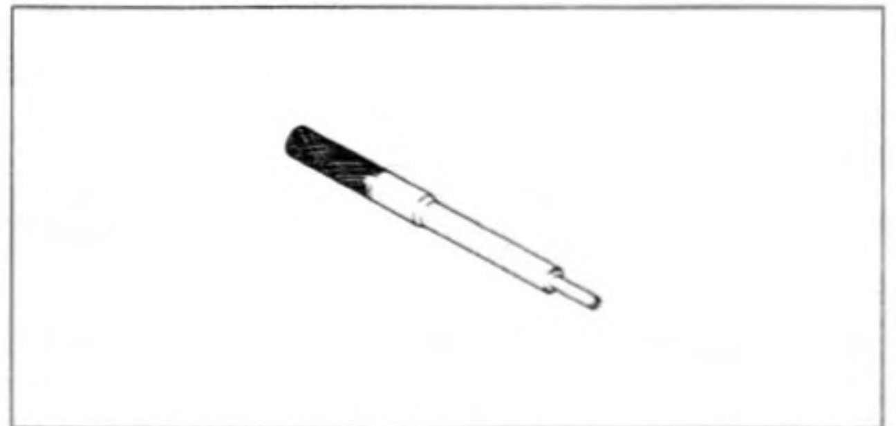
Valve Guide Reamer, \Phi 4 : 57001-1274
